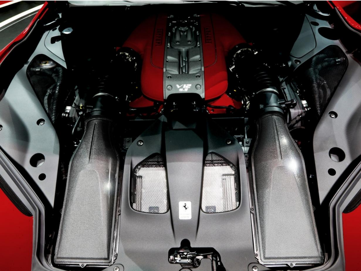
Le scatole filtro in fibra di carbonio permettono un alleggerimento del peso rispetto ai particolari di serie: la fibra di carbonio è infatti un materiale ultraleggero, resistente al calore, che rimane inalterato nel tempo grazie alle qualità tecniche ed estetiche del componente e allo strato protettivo trasparente con cui è rivestito.
