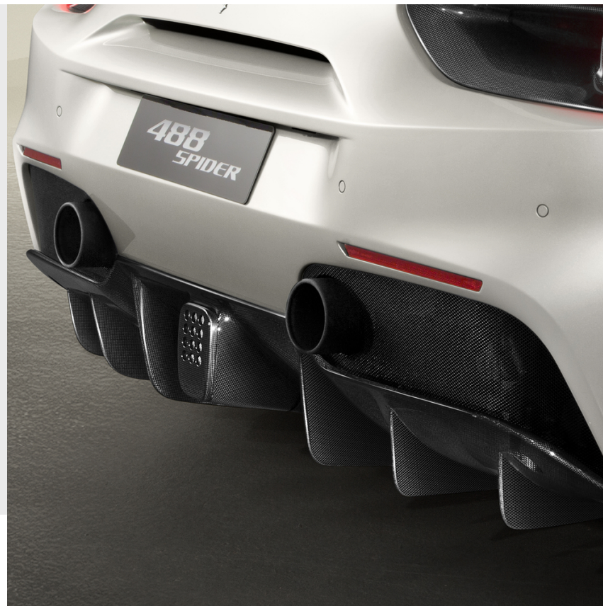
Mostrina retronebbia in fibra di carbonio, con telecamera analogica
