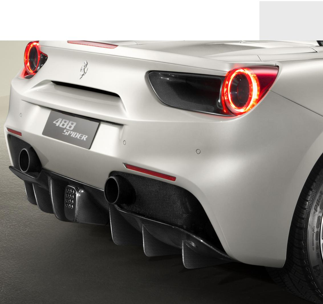
Progettato per aumentare il carico sul posteriore e favorire l'estrazione di aria dal sotto-scocca, il diffusore in fibra di carbonio esalta l'estetica della vettura e soddisfa le esigenze tecniche, contribuendo alla riduzione di peso.
