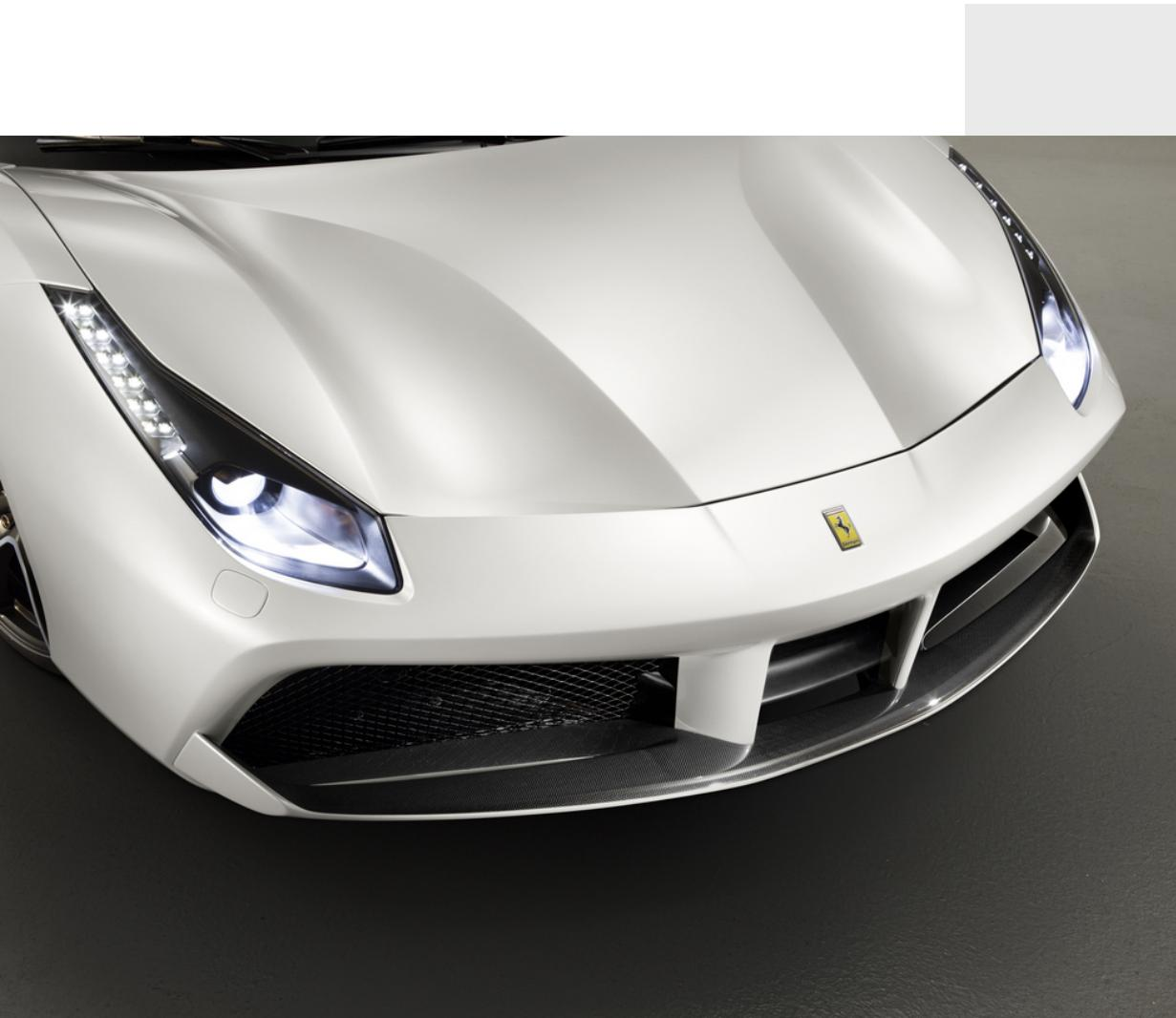
Progettato con le più innovative tecniche di fluidodinamica - e testato in galleria del vento per ottimizzare le performance del sottoscocca - lo spoiler anteriore in fibra di carbonio è un elemento fondamentale per personalizzare l'estetica della vettura e per garantirne l'aerodinamica.
