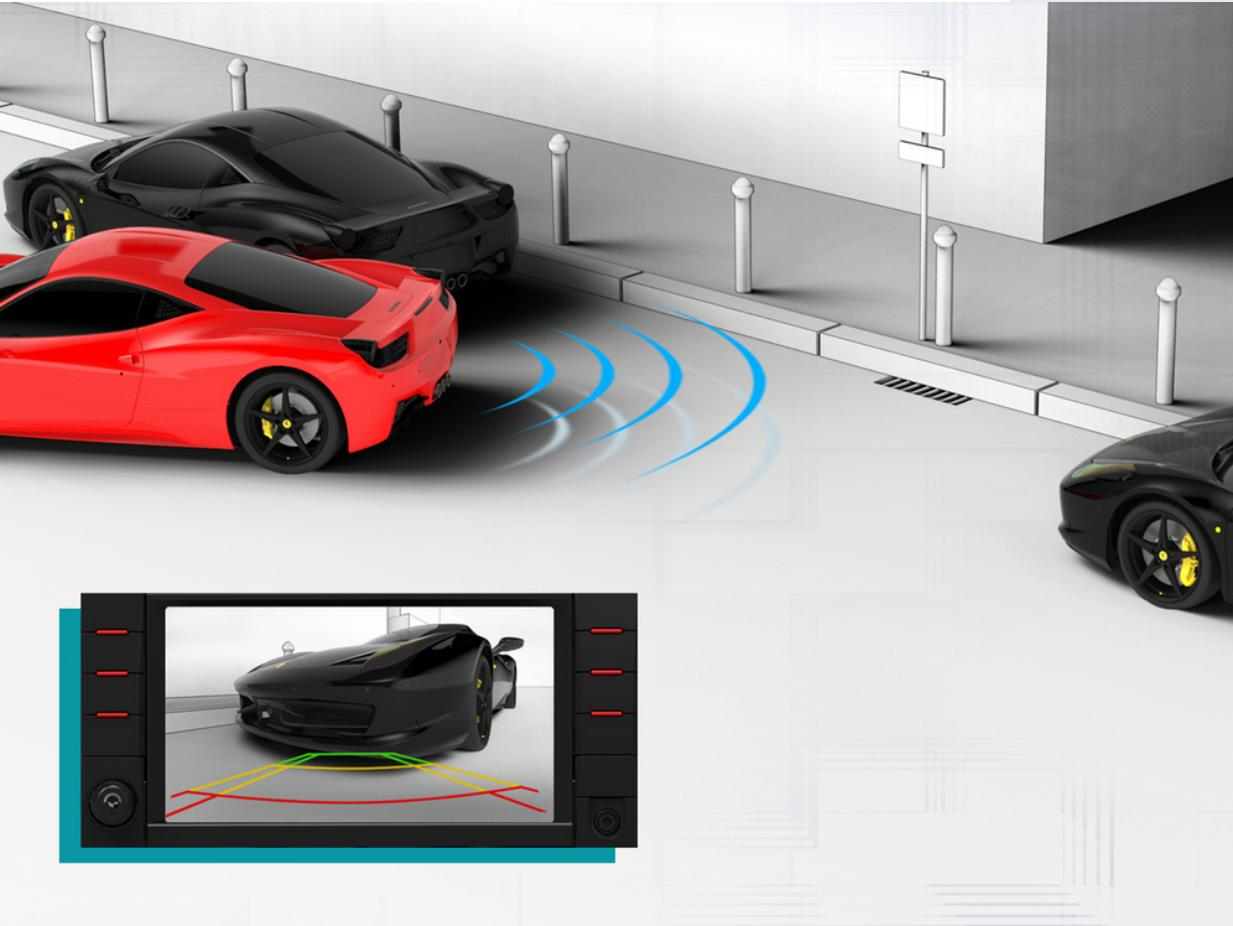
Il sistema di parking camera offerto da Ferrari permette di evitare impatti accidentali durante le fasi di parcheggio. I kit, che includono le telecamere anteriori e posteriori, mostrano sul quadro strumenti le informazioni necessarie e, grazie all'integrazione dei sensori di parcheggio e a una comoda griglia virtuale, supportano il guidatore nelle fasi di manovra.
