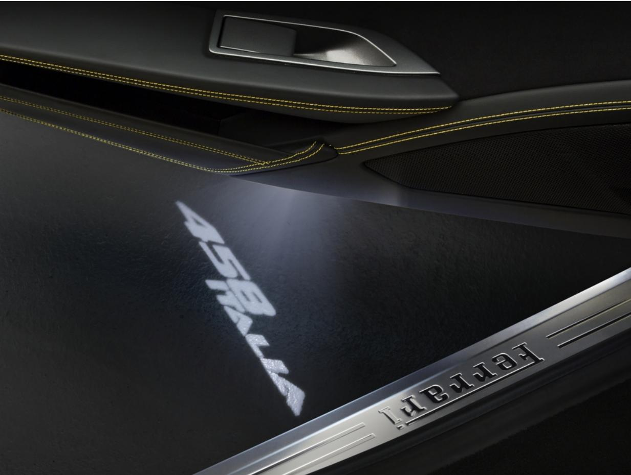
L'illuminazione sottoporta permette di aggiungere alla propria Ferrari un ulteriore componente dallo stile unico: il kit è composto da due plafoniere e quattro serie di lenti speciali, capaci di proiettare il logo della vettura o il Cavallino Rampante direttamente sul suolo, nella zona di apertura delle portiere.
