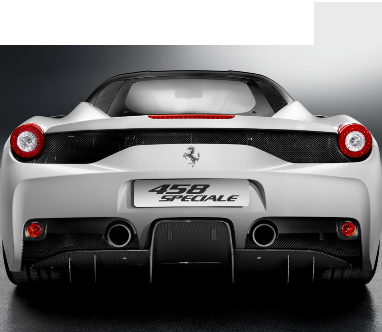
Progettato per aumentare il carico sul posteriore e favorire l'estrazione di aria dal sotto-scocca, il diffusore in fibra di carbonio esalta l'estetica della vettura e soddisfa le esigenze tecniche, contribuendo alla riduzione di peso.
