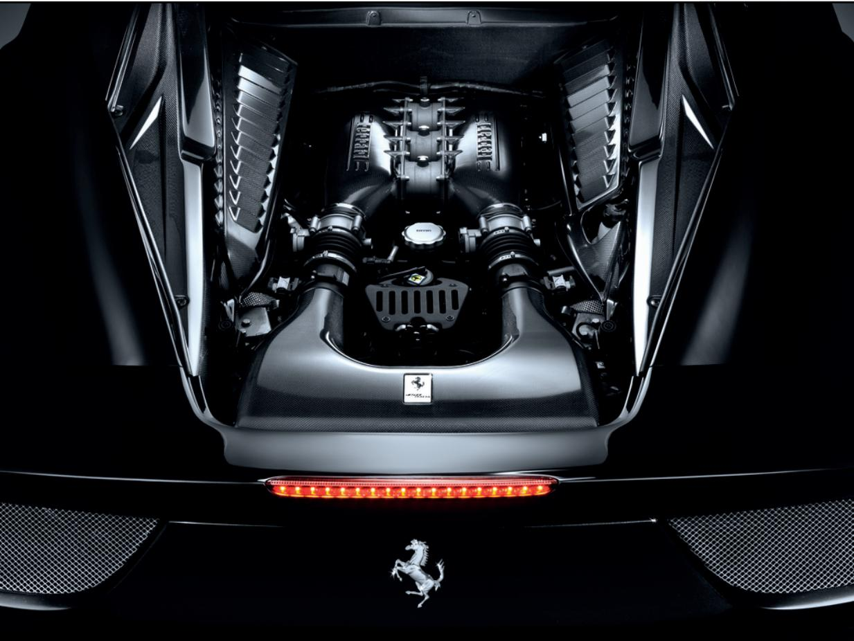
Uno dei componenti tecnici alla base delle prestazioni del motore è l'airbox, le cui caratteristiche come il volume, la forma, la lunghezza dei tromboncini di aspirazione, la dimensione e la rugosità delle superfici, contribuiscono ad ottenere il massimo delle prestazioni, consentendo al motore di aspirare più aria possibile.
