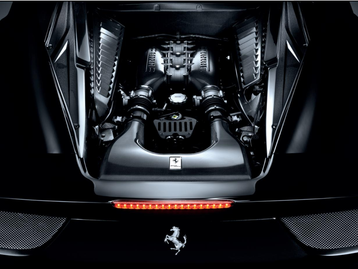
Le paratie motore in fibra di carbonio permettono un alleggerimento del peso rispetto ai particolari di serie: la fibra di carbonio è infatti un materiale ultraleggero, resistente al calore, che rimane inalterato nel tempo grazie alle qualità tecniche ed estetiche del componente e allo strato protettivo trasparente con cui è rivestito.
