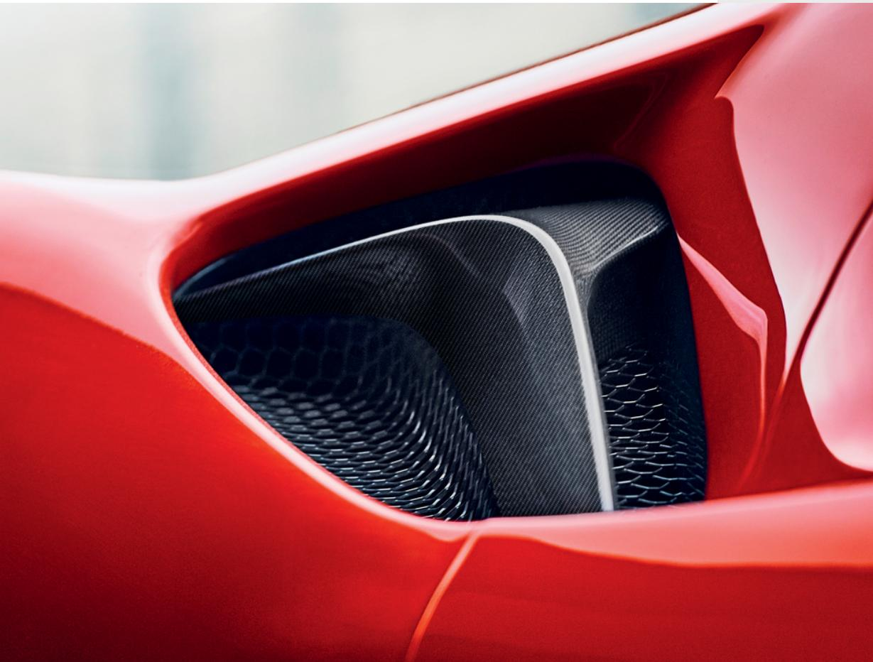
Pour mettre en valeur des éléments emblématiques tels que les splitters des prises d'air latérales, servant à diviser le flux d'air et assurer les performances maximales du moteur, Ferrari Genuine propose la variante en fibre de carbone. Cette solution permet de réduire le poids total et de souligner le caractère sportif de la voiture, en lui donnant un aspect nerveux et fortement distinctif.
