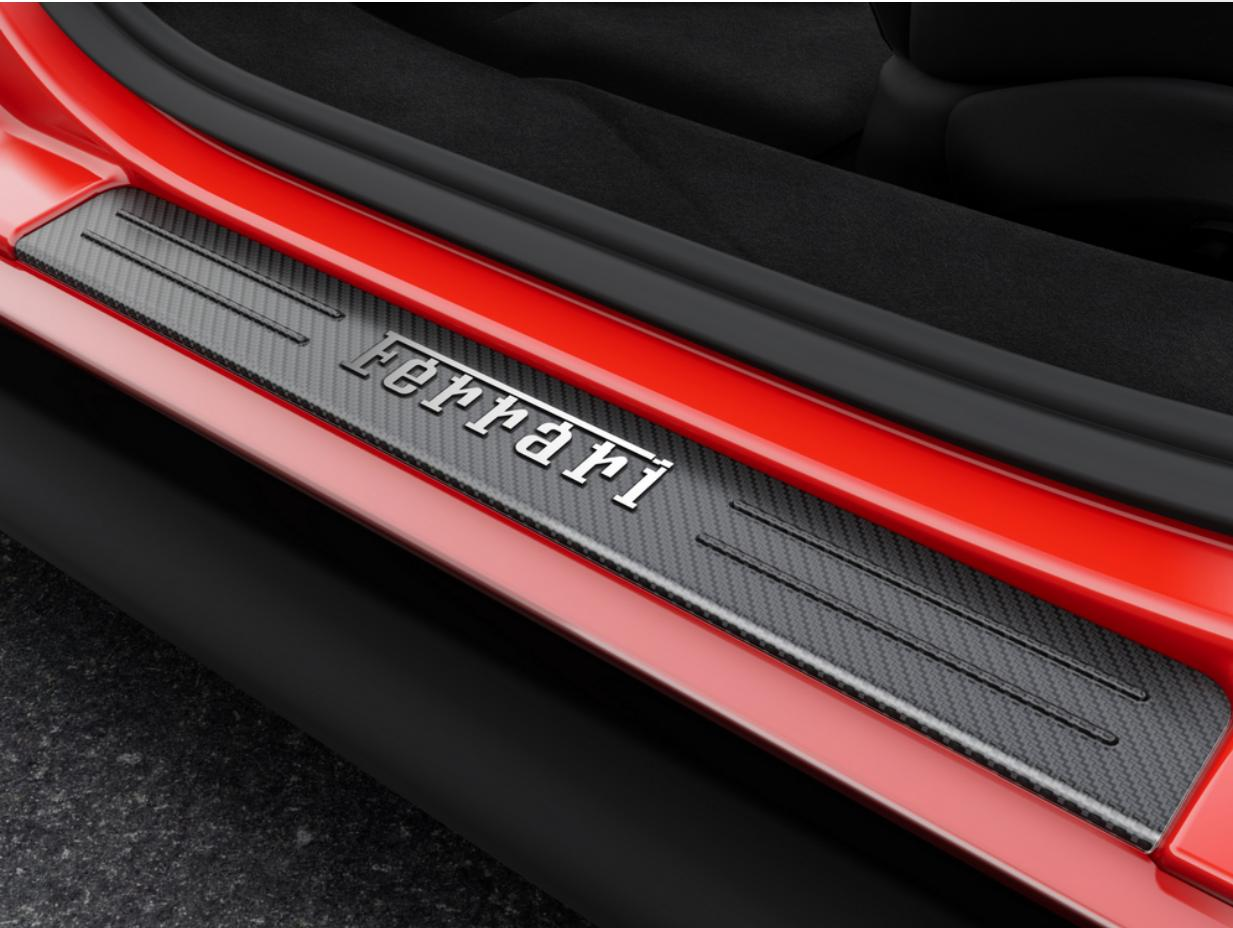
Grâce au programme Ferrari Genuine, il est possible de remplacer le seuil de porte en aluminium par une variante entièrement en fibre de carbone. Le seuil de porte est enrichi du logo Ferrari en acier.
