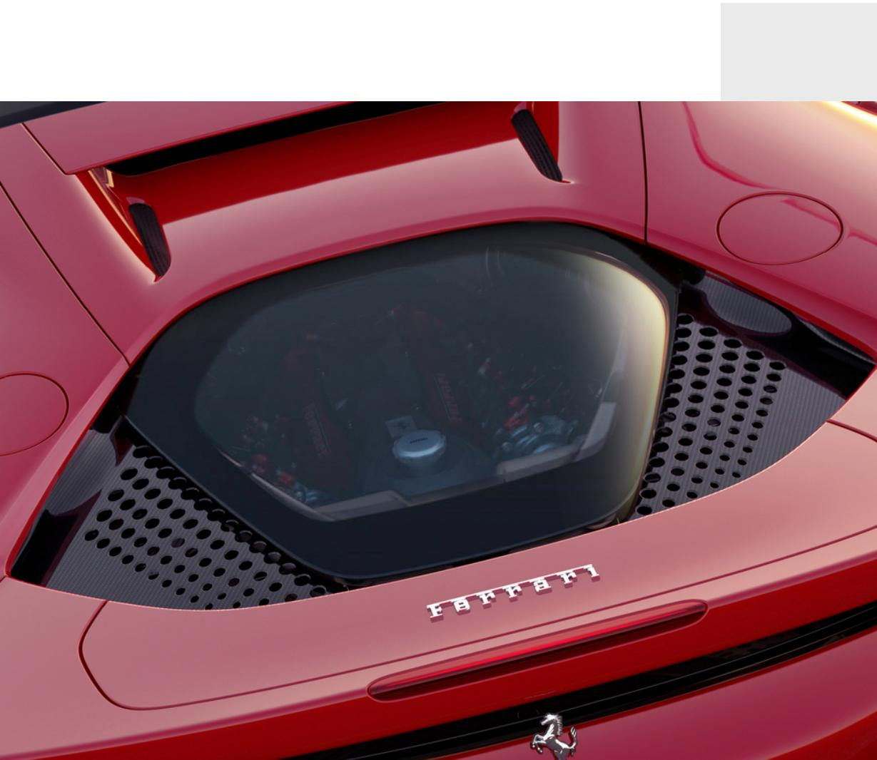
Les couvercles, installés dans la zone d'extrémité de la lunette arrière, assurent, grâce à leur forme particulière, la bonne circulation de l'air du compartiment moteur.
