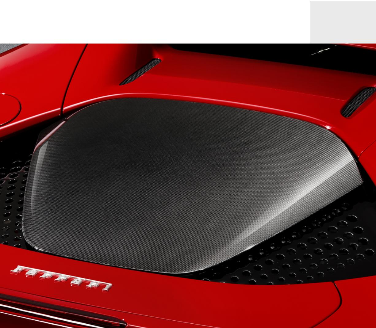
Conçu par le Ferrari Centro Stile pour réduire le poids du composant, le couvercle du compartiment moteur en fibre de carbone est entièrement composé de matériaux de haute technologie.
