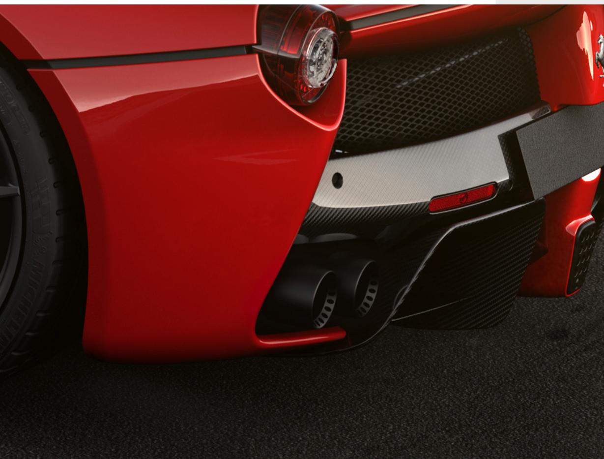
Les sorties d'échappement en acier avec revêtement en céramique se distinguent par l'utilisation de matériaux de pointe et par des traitements de surface spécifiques qui confèrent à la voiture un aspect plus dynamique et sportif. Le revêtement en céramique permet de disperser de grandes quantités de chaleur, de résister à d'éventuels dommages accidentels et, grâce à la technologie spécifique utilisée, de préserver l'esthétique au fil du temps.
