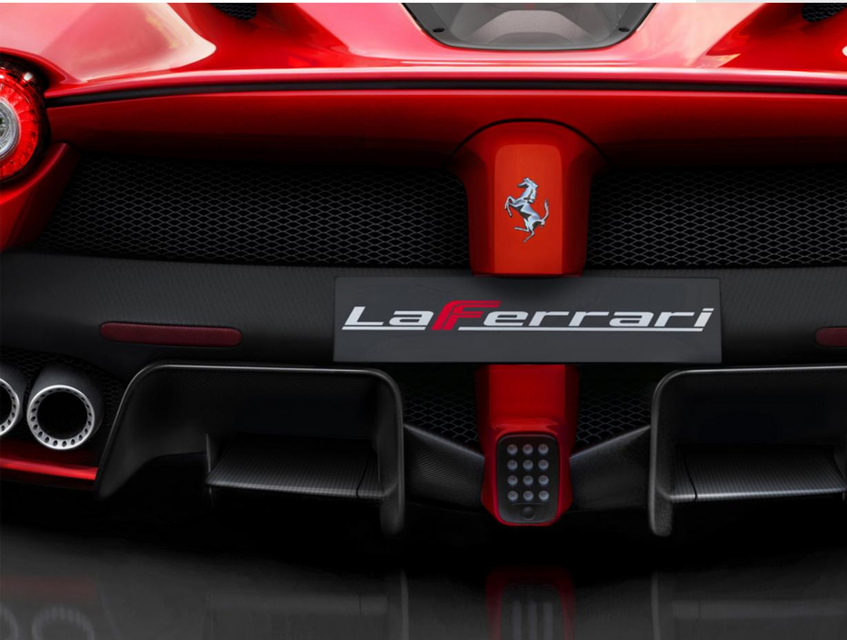
Conçu pour augmenter la charge à l'arrière et favoriser l'extraction d'air par le dessous de caisse, le diffuseur en fibre de carbone exalte l'esthétique de la voiture tout en répondant aux exigences techniques et en contribuant à réduire le poids.
