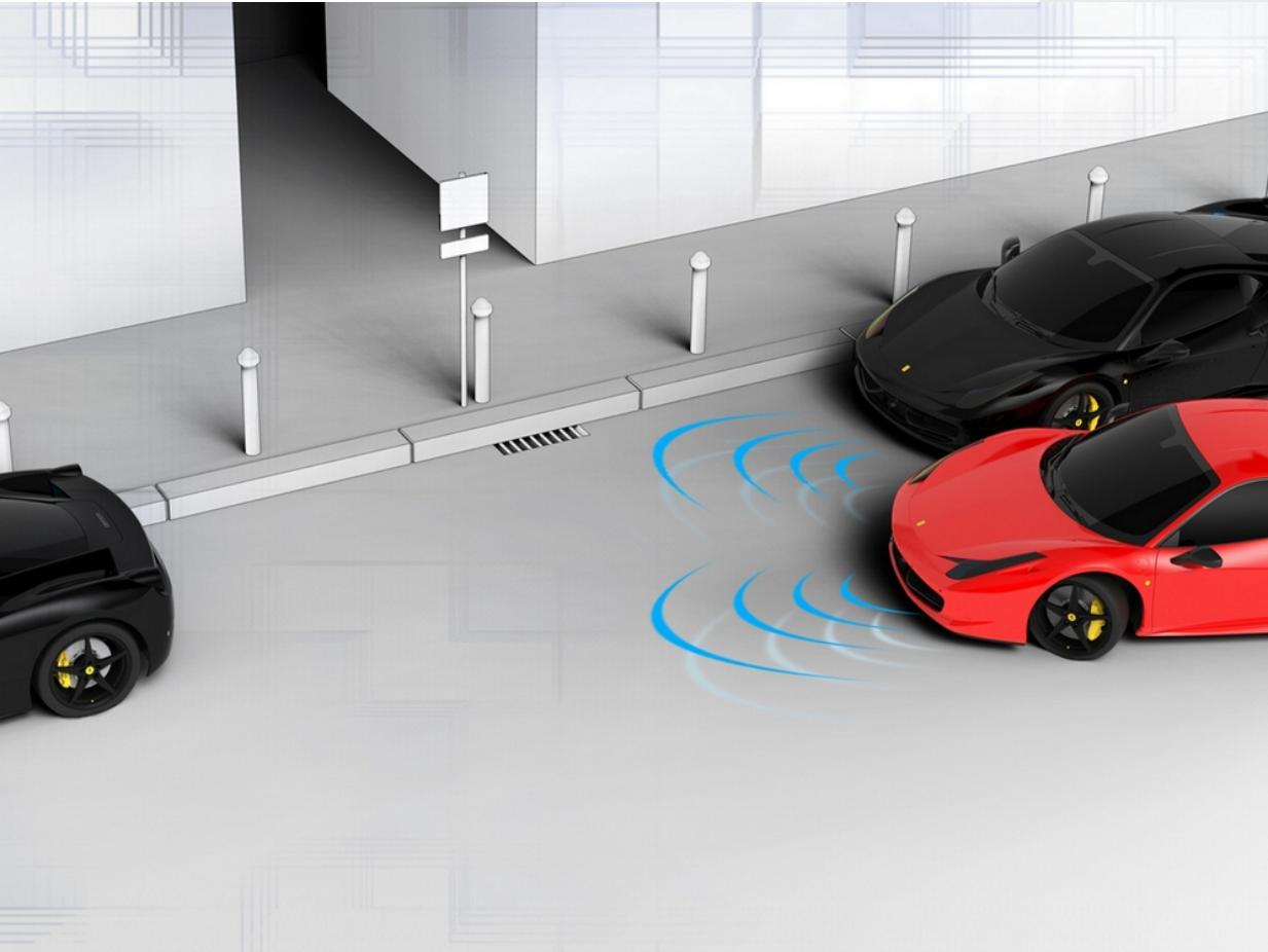
Les capteurs d'aide au stationnement développés par Ferrari indiquent par un signal sonore la présence d'obstacles situés devant ou derrière la voiture, fournissant au conducteur des informations sur la distance en phase de rapprochement. Grâce à l'intégration directe avec les informations sonores et visuelles générées par le système, ces capteurs permettent d'éviter d'éventuels contacts accidentels dans les phases de manœuvre.
