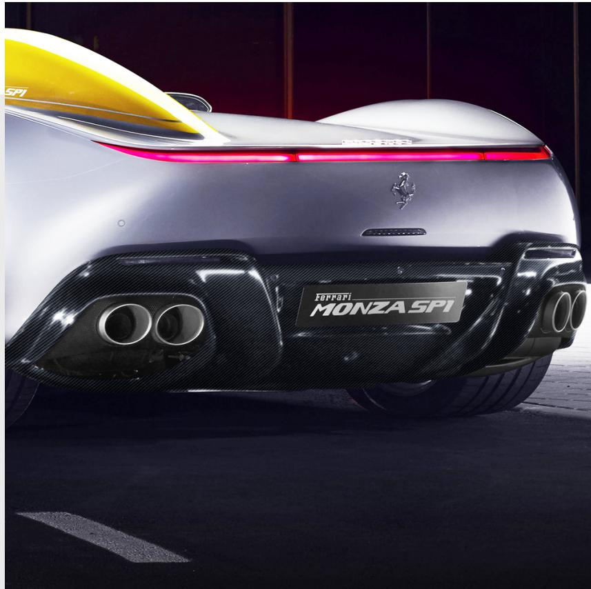
Diffuseur arrière en fibre de carbone
