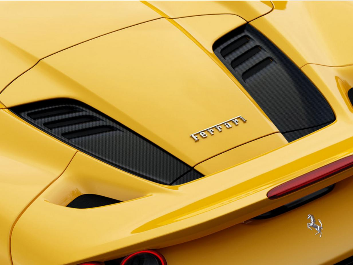
Le conduit aérodynamique arrière sur la partie terminale de la lunette arrière est un élément fondamental pour l'aérodynamique arrière de la voiture.
