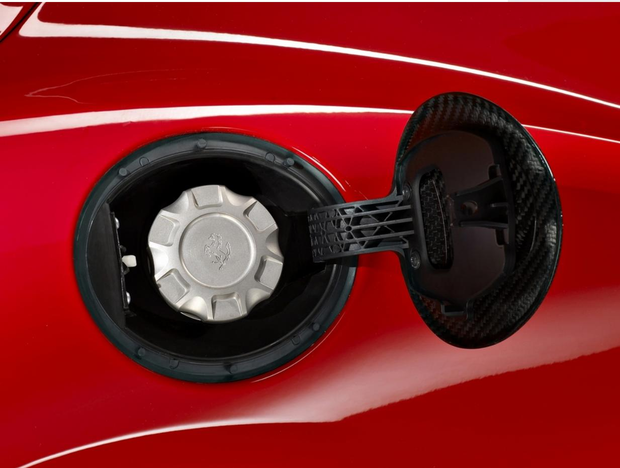
Les technologies et les matériaux utilisés pour réaliser le bouchon de réservoir de carburant en titane dérivent directement de l'expérience acquise dans le monde des courses.
