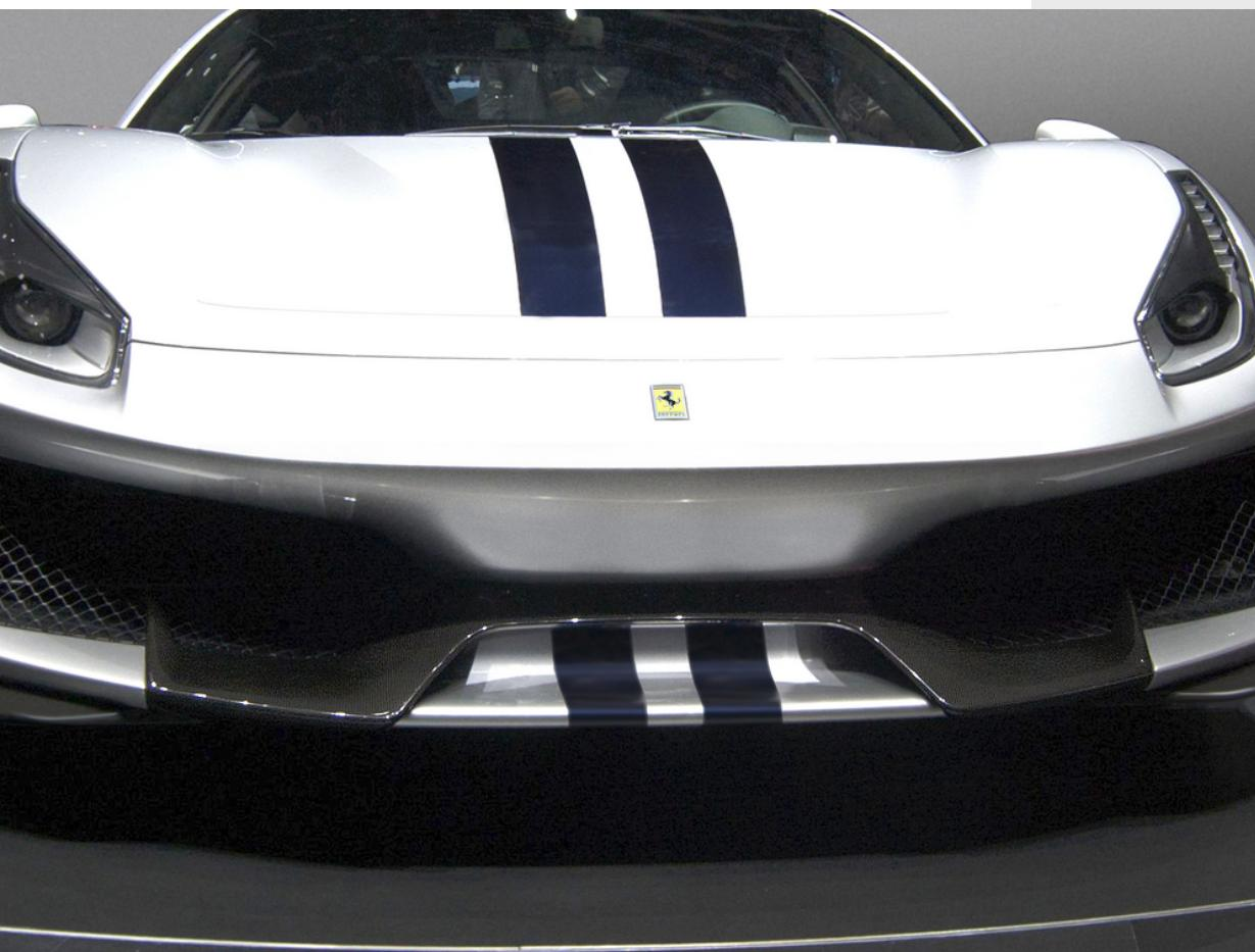
Conçu en appliquant les techniques les plus innovantes de la dynamique des fluides - et testé en soufflerie pour optimiser les performances du dessous de caisse - le spoiler avant en fibre de carbone est un élément fondamental pour personnaliser l'esthétique de la voiture et garantir l'aérodynamique.
