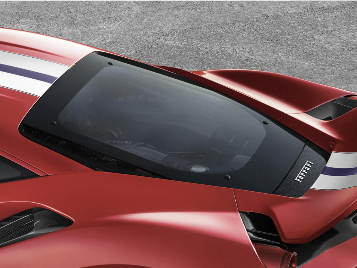
Conçu spécialement pour réduire le poids du composant, le capot moteur en carbone est totalement réalisé avec des matériaux de pointe, provenant directement du monde du sport. Le châssis entièrement en carbone supporte une lunette en Lexan, un polycarbonate qui remplace le verre sur les voitures de course. Il garantit transparence, légèreté et longévité grâce à un traitement spécifique anti-éraflures.
