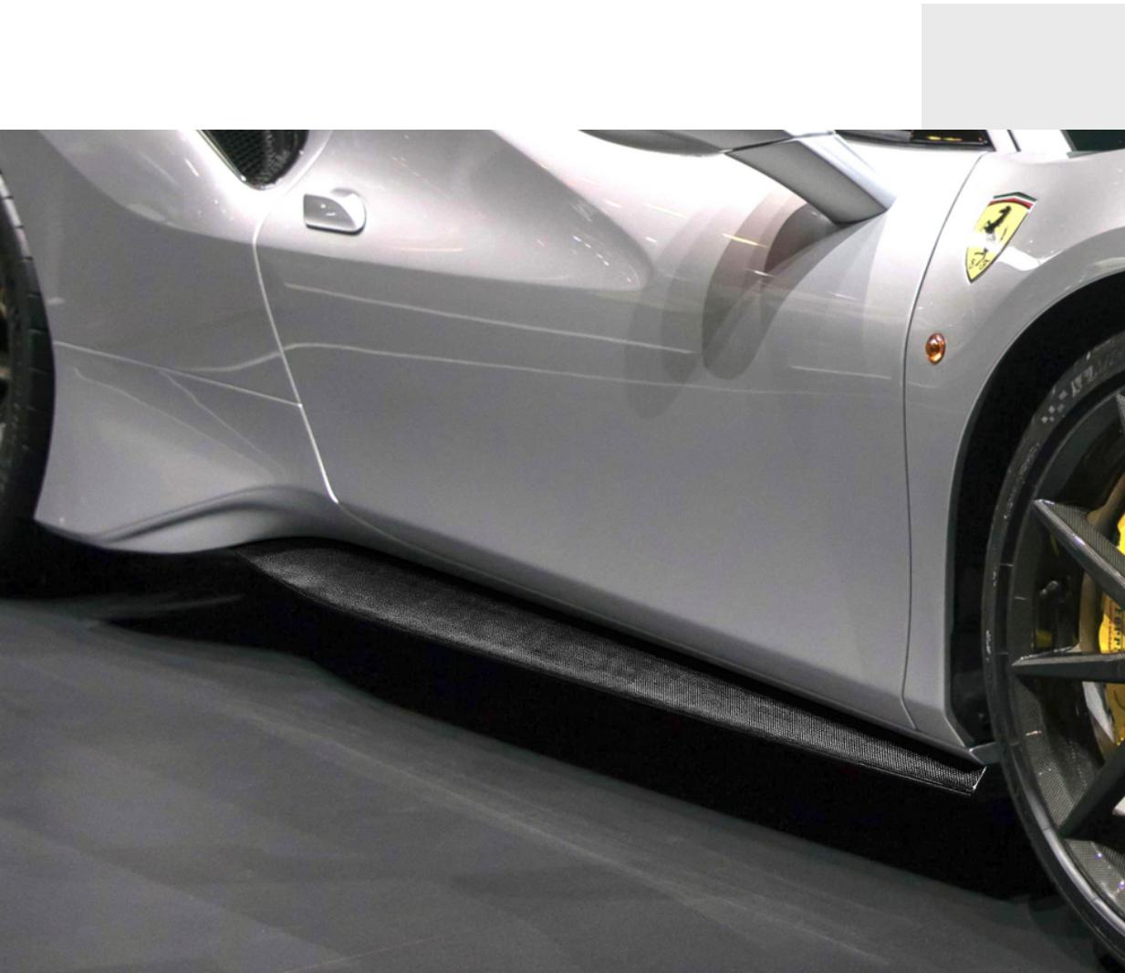
Ferrari Genuine propose de remplacer le traditionnel bas de porte installé en voiture par le kit bas de porte apparent en fibre de carbone.
