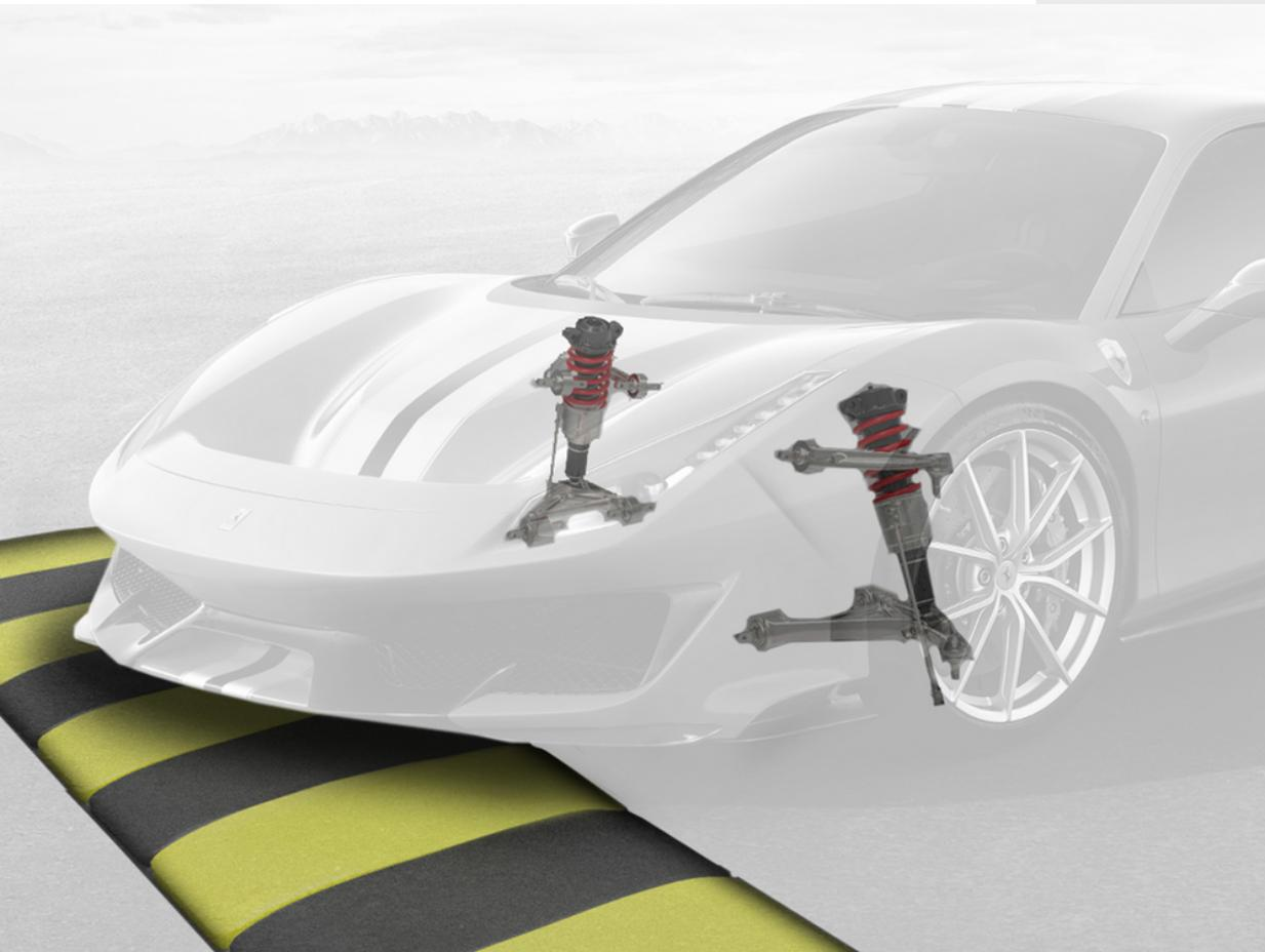
Pour un confort de conduite maximal, Ferrari Genuine propose un système qui assiste le franchissement de dos-d'âne ou de rampes et préserve le bon état de la voiture. L'élévateur, qui agit sur les amortisseurs, soulève la voiture de 40 mm environ.
