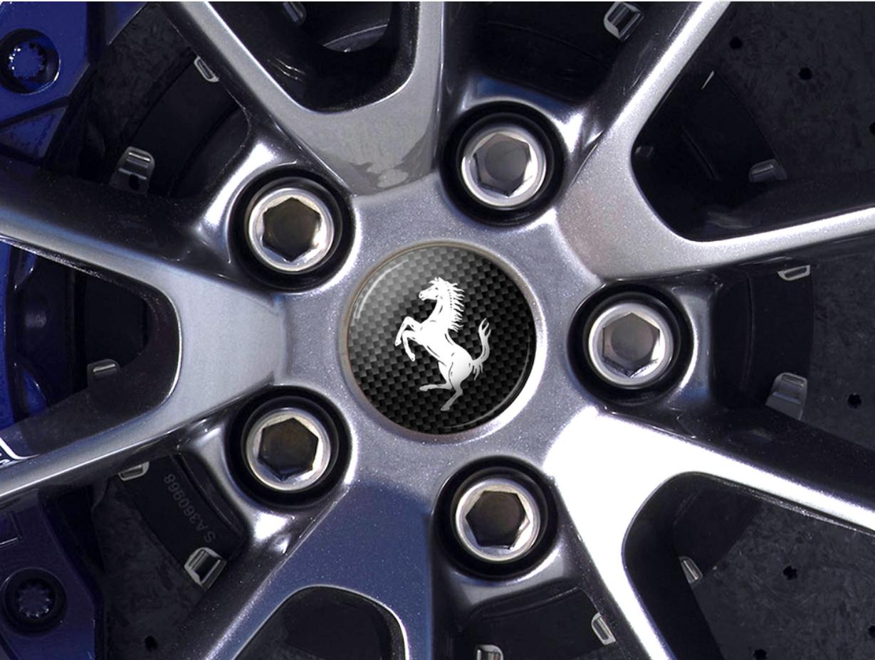
Pour personnaliser votre voiture, il est possible d'installer des cuvettes centrales de jante racing comme alternative aux cuvettes standard.
