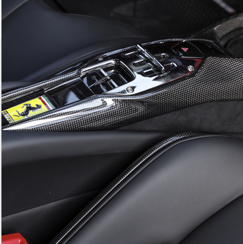
Tunnel en fibre de carbone, opaque
