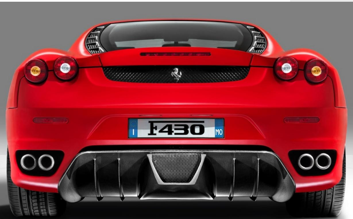
Conçu pour augmenter la charge à l'arrière et favoriser l'extraction d'air par le dessous de caisse, le diffuseur en fibre de carbone exalte l'esthétique de la voiture tout en répondant aux exigences techniques et en contribuant à réduire le poids.
