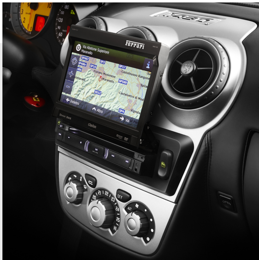
Système infotainment 1DIN Ferrari Genuine, avec caméra d'aide au stationnement
