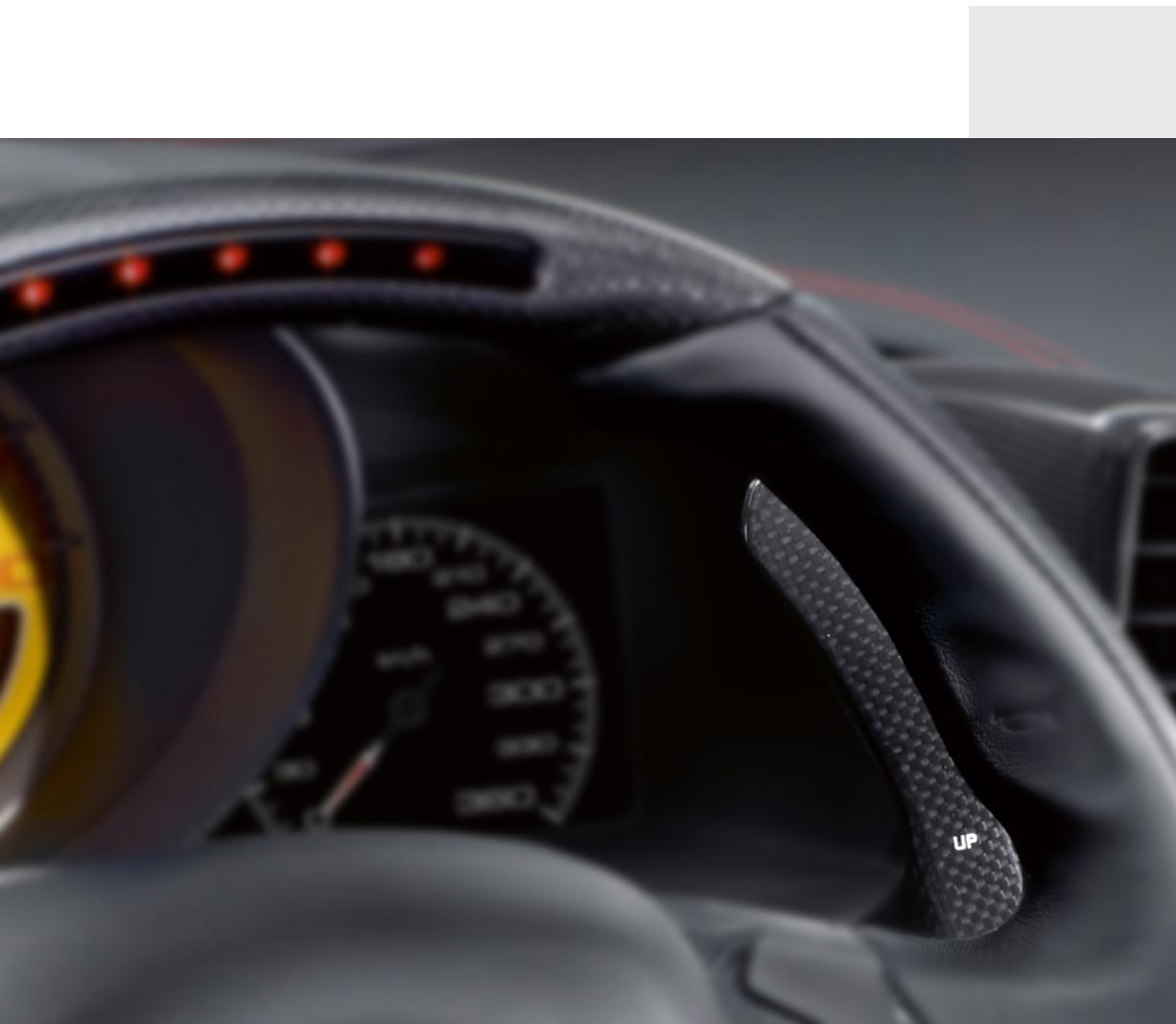
Il est possible de remplacer les leviers F1 situés derrière le volant par un kit de palettes entièrement réalisées en fibre de carbone.
