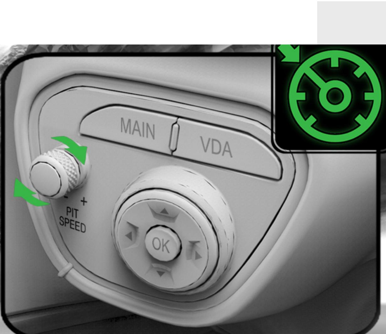
Le Cruise Control est un dispositif électronique qui permet de maintenir une vitesse constante durant les longs trajets sur l'autoroute.
