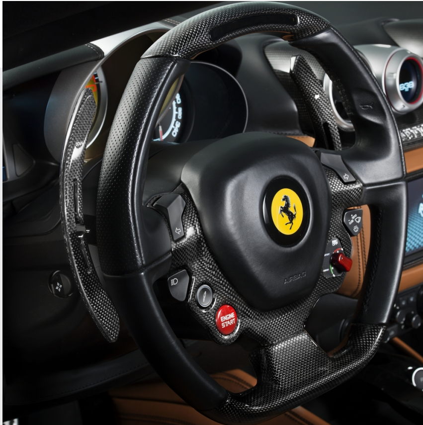
Palettes au volant pour Boîte de vitesse F1 Racing, en fibre de carbone mate
