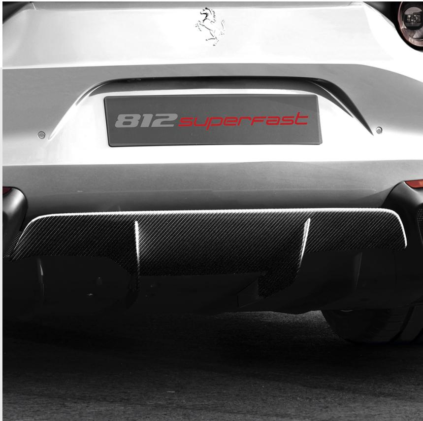
Diffuseur arrière en fibre de carbone
