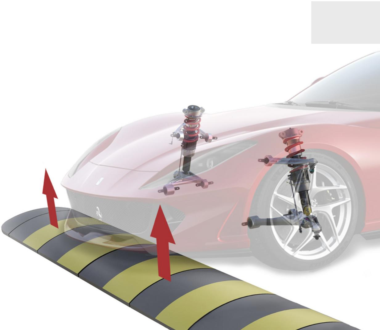
Pour un confort de conduite maximal, Ferrari Genuine propose un système qui assiste le franchissement de dos-d'âne ou de rampes et préserve le bon état de la voiture. L'élévateur, qui agit sur les amortisseurs, soulève la voiture de 40 mm environ.
