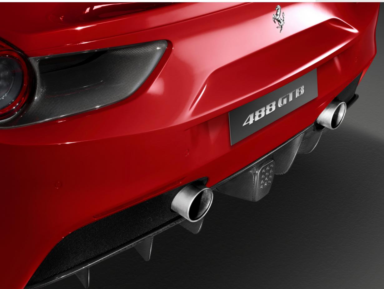
Développées sur la même base stylistique que les sorties de série, les sorties d'échappement en titane se distinguent par une réduction de poids de 50% et une finition de surface qui permet de préserver leur aspect esthétique. L'utilisation de ce matériau à la pointe de la technologie garantit une résistance maximale aux agents extérieurs, démontrant ainsi les activités d'amélioration continue du produit menées par Ferrari.
