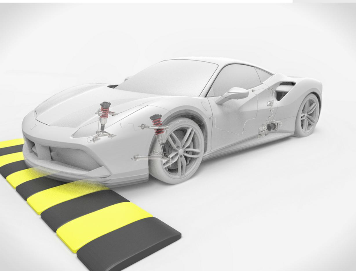
Pour un confort de conduite maximal, Ferrari Genuine propose un système qui assiste le franchissement de dos-d'âne ou de rampes et préserve le bon état de la voiture. L'élévateur, qui agit sur les amortisseurs, soulève la voiture de 40 mm environ.
