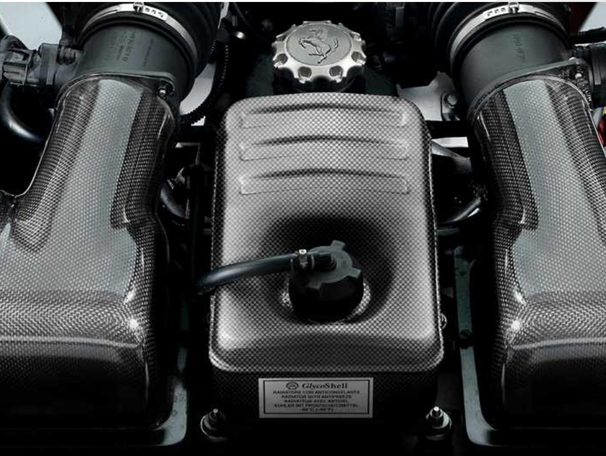
Par rapport aux pièces de série, les protections du compartiment moteur en fibre de carbone permettent d'alléger le poids de la voiture. De fait, la fibre de carbone est un matériau ultraléger, résistant à la chaleur, qui ne se modifie pas dans le temps grâce à ses propriétés techniques et esthétiques, ainsi qu'à son revêtement transparent.
