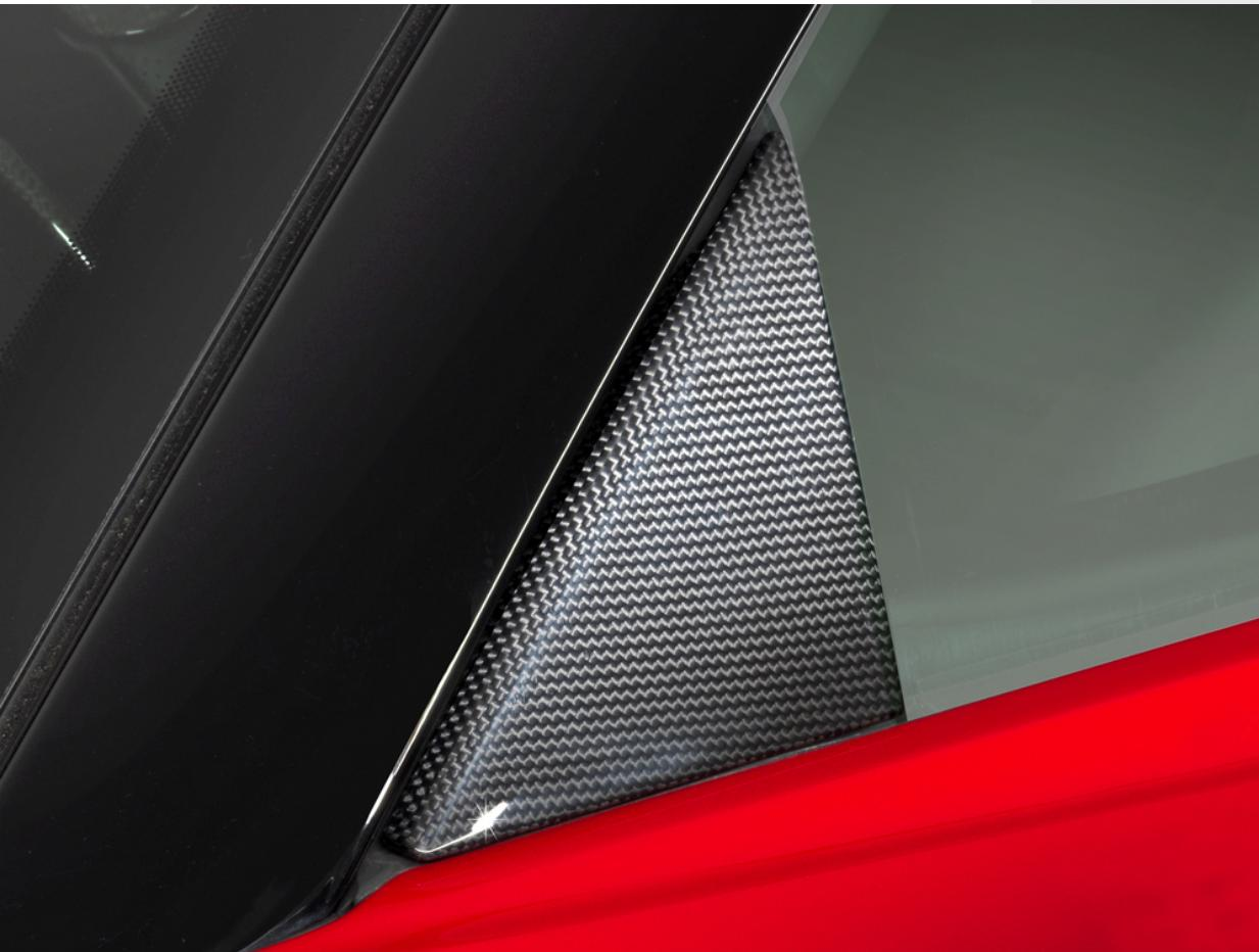
el triángulo del cristal lateral de fibra de carbono da un toque de exclusividad y contribuye a reducir el peso total del vehículo gracias a la ligereza del material. La fibra de carbono, además, exalta el carácter deportivo y representa un valor adicional para los exteriores, manteniendo intacto su estilo inconfundible.
