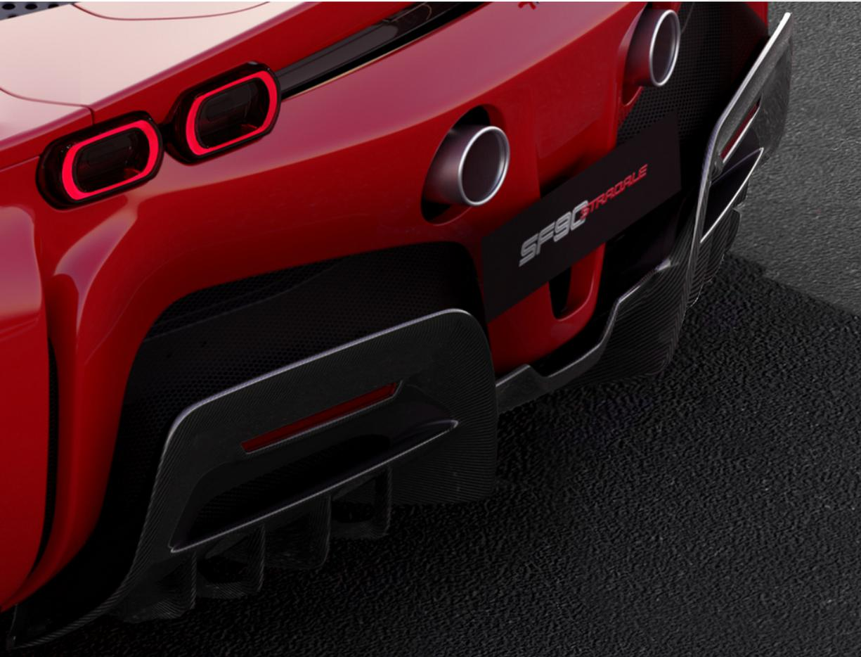
Diseñado para aumentar la carga en la parte trasera y facilitar la extracción de aire de los bajos del bastidor, el difusor de fibra de carbono resalta la estética del vehículo y satisface las exigencias técnicas, contribuyendo a la reducción de peso.
