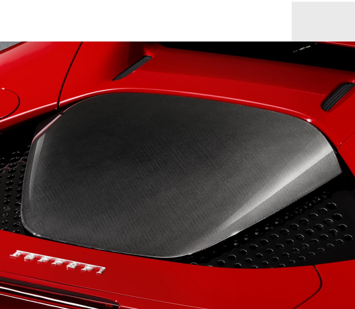
Diseñada por Ferrari Centro Stile para reducir el peso del componente, la cubierta del compartimento del motor de fibra de carbono está hecha completamente de materiales de alta tecnología.
