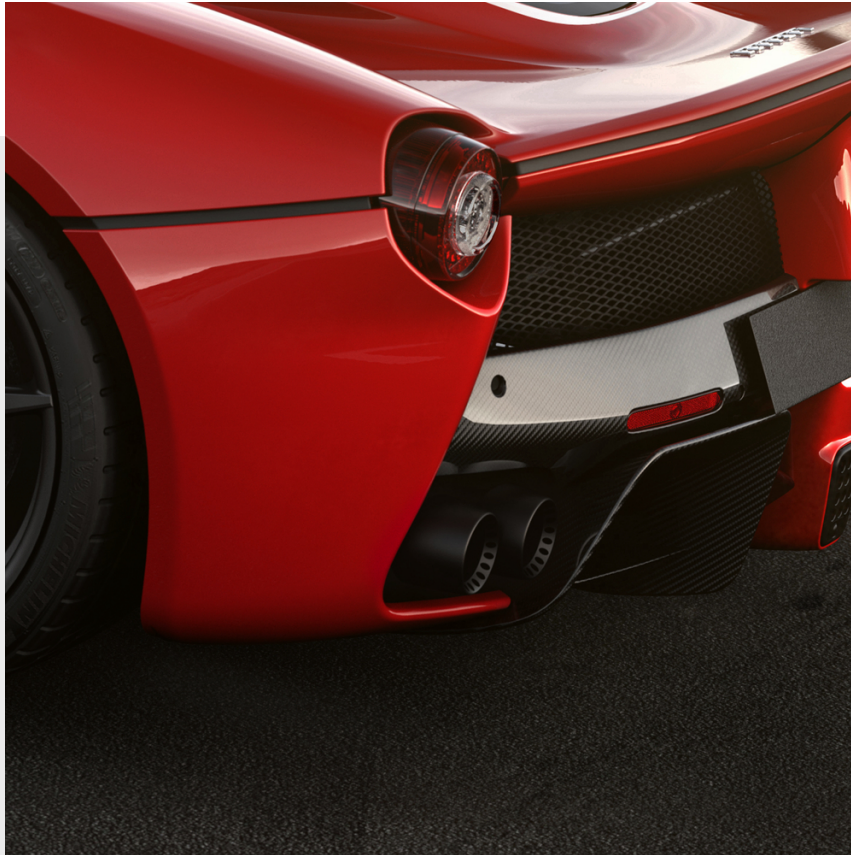
Colines de escape con revestimiento cerámico, negro, izquierdo
