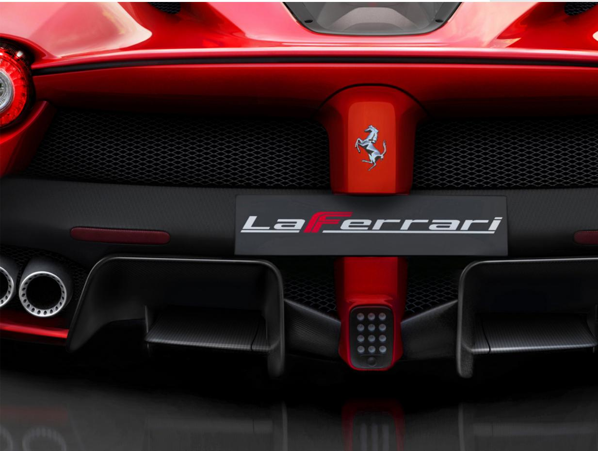
Diseñado para aumentar la carga en la parte trasera y facilitar la extracción de aire de los bajos del bastidor, el difusor de fibra de carbono resalta la estética del vehículo y satisface las exigencias técnicas, contribuyendo a la reducción de peso.
