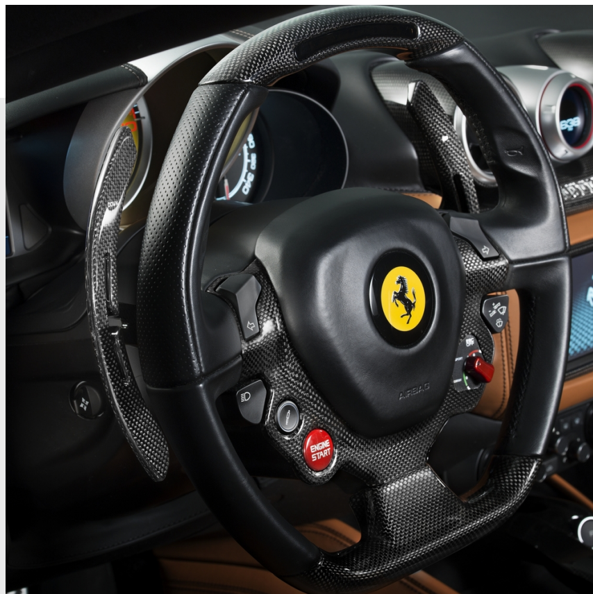
Levas de cambio F1 racing, de fibra de carbono opaca
