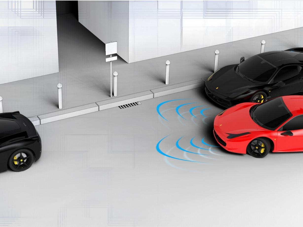
Los sensores de aparcamiento desarrollados por Ferrari indican con una señal acústica la presencia de obstáculos situados delante o detrás del vehículo, proporcionando al conductor información sobre la distancia en la fase de aproximación. Al integrar la información visual directa con la acústica y visual generada por el sistema, estos sensores permiten evitar eventuales contactos accidentales durante las maniobras.
