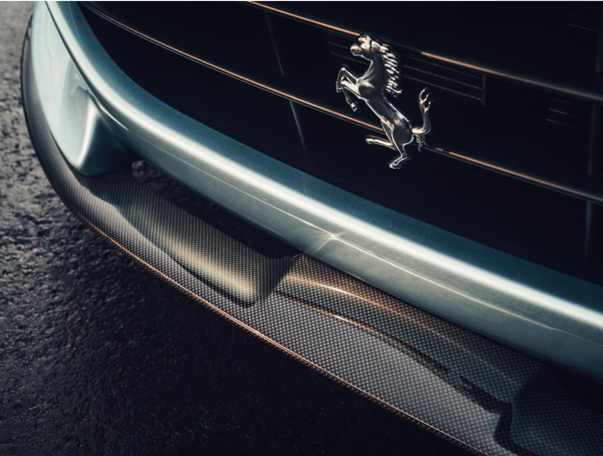
Diseñado con las más innovadoras técnicas de fluidomecánica y probado en el túnel de viento para optimizar las prestaciones de los bajos del bastidor, el spoiler delantero de fibra de carbono es un elemento fundamental para personalizar la estética del vehículo y para garantizar su aerodinámica.
