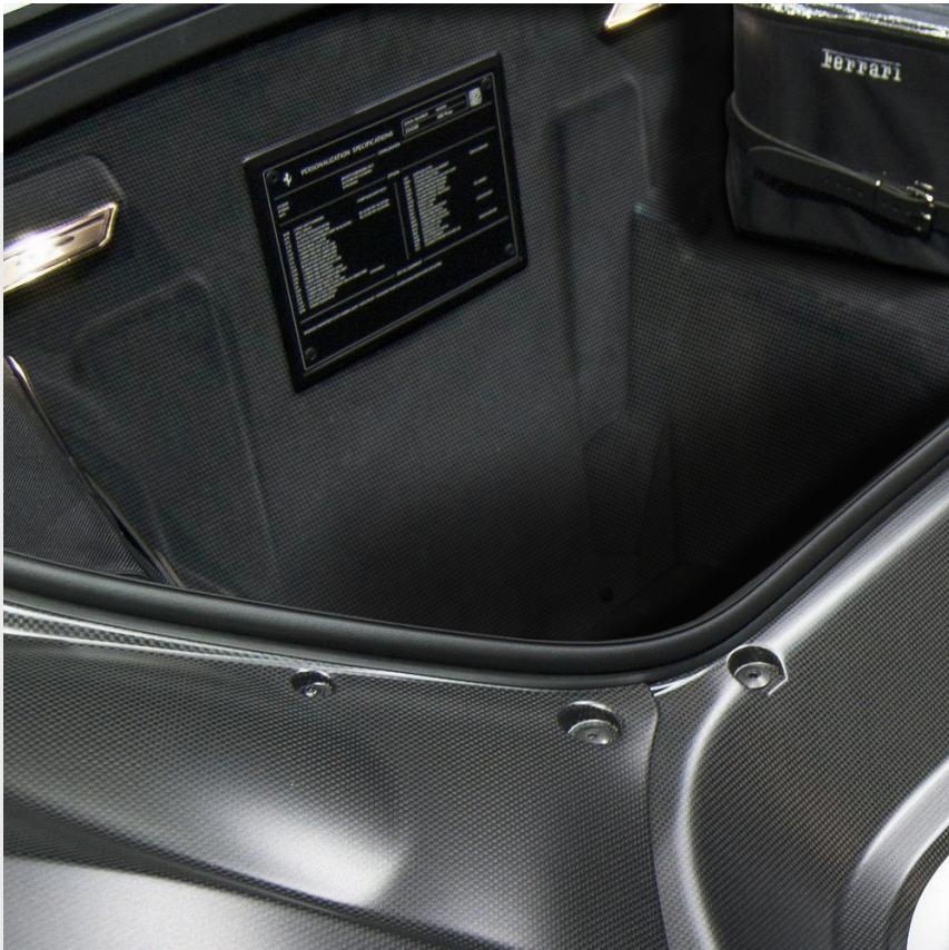
Compartimento de maletero de fibra de carbono, receptáculo de maletero con rueda de repuesto
