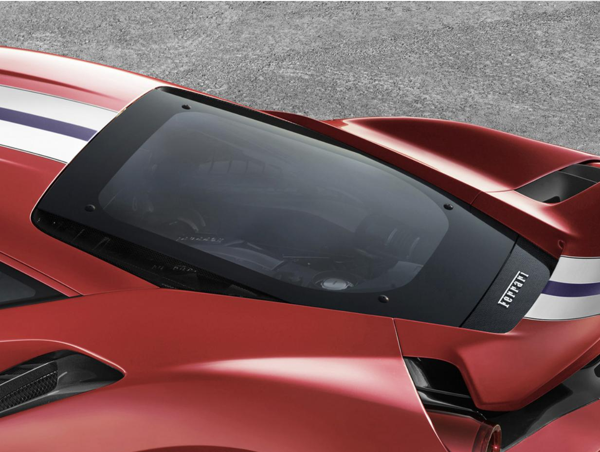
Diseñado específicamente para reducir el peso del componente, el capó motor de carbono está realizado en su totalidad con materiales de alto contenido tecnológico, derivados directamente de la competición. La estructura completamente de carbono sostiene una luneta de Lexan, un policarbonato utilizado en las carreras para sustituir el cristal, que garantiza transparencia, ligereza y longevidad gracias a un tratamiento específico antiarañazos.
