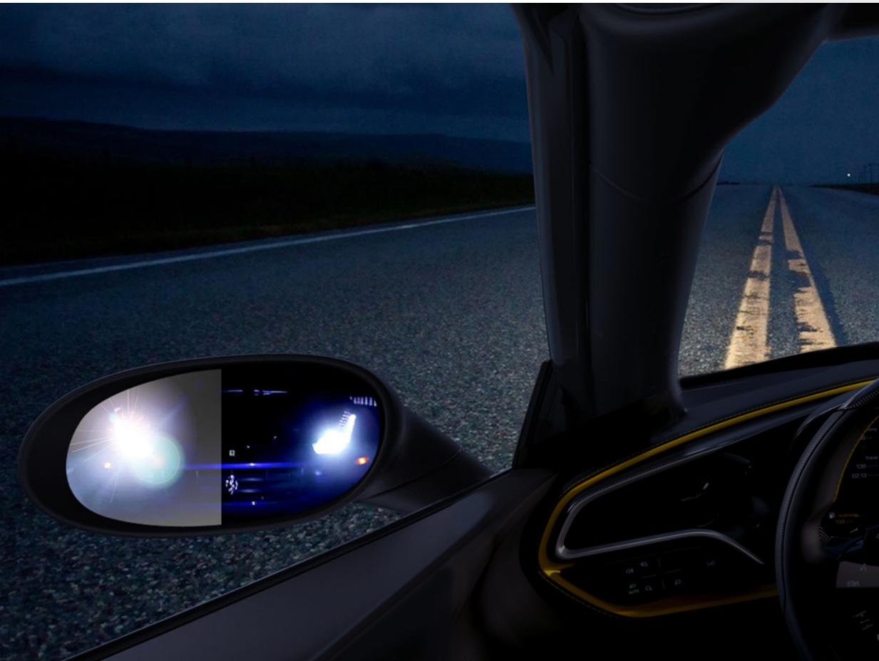
Los Espejos Electrocrómicos reducen eficazmente el efecto deslumbrante de la luz reflejada en el conductor: gracias a una tecnología fotocromática especial, el Espejo Electrocrómico se oscurece por sí solo rápidamente, según la intensidad de la luz incidente.
