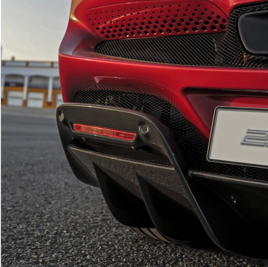
Difusor trasero de fibra de carbono, opaco
