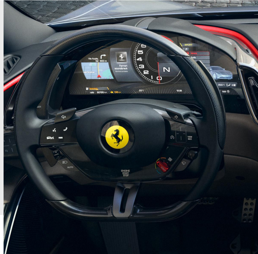
Levas del cambio F1 de fibra de carbono
