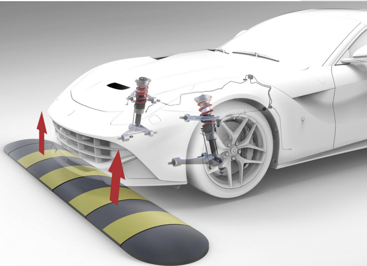
Para garantizar la máxima practicidad en cualquier situación de conducción, Ferrari Genuine ofrece un sistema que facilita la superación de baches o rampas, salvaguardando al mismo tiempo la integridad del vehículo. El elevador, que actúa sobre los amortiguadores del vehículo, permite una elevación de unos 40 mm.
