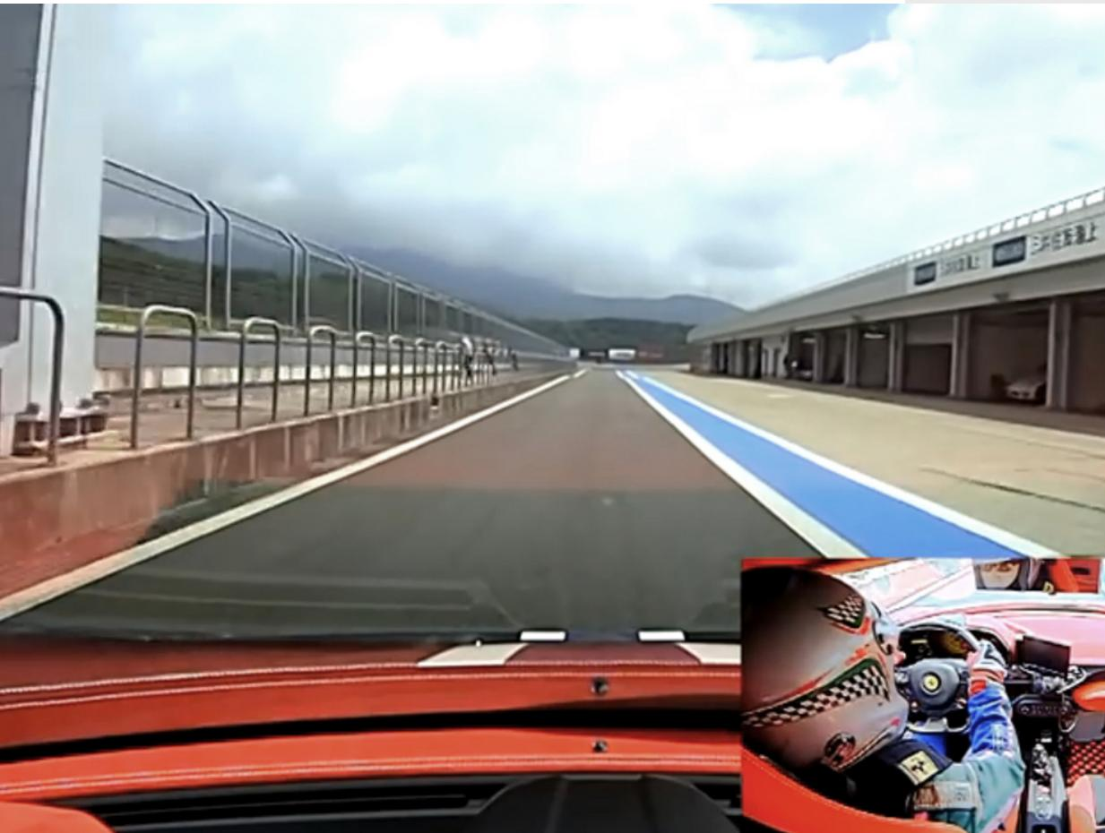
Las cámaras de circuito son un accesorio opcional que se añade al kit de telemetría de Ferrari: instaladas en el habitáculo, para poder grabar tanto el trazado del circuito como la posición de conducción, permiten registrar la experiencia de conducción y volver a ver en vídeo a alta resolución el rendimiento del conductor, analizando las trayectorias, los puntos de frenada y la técnica de conducción.
